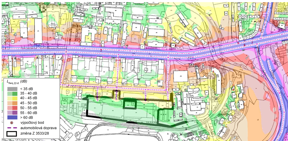
Obr. 9. L_{Aeq} , 22 až 6 hod, stav po změně v kumulaci, silniční doprava, izofony ve výšce 4 m nad terénem
