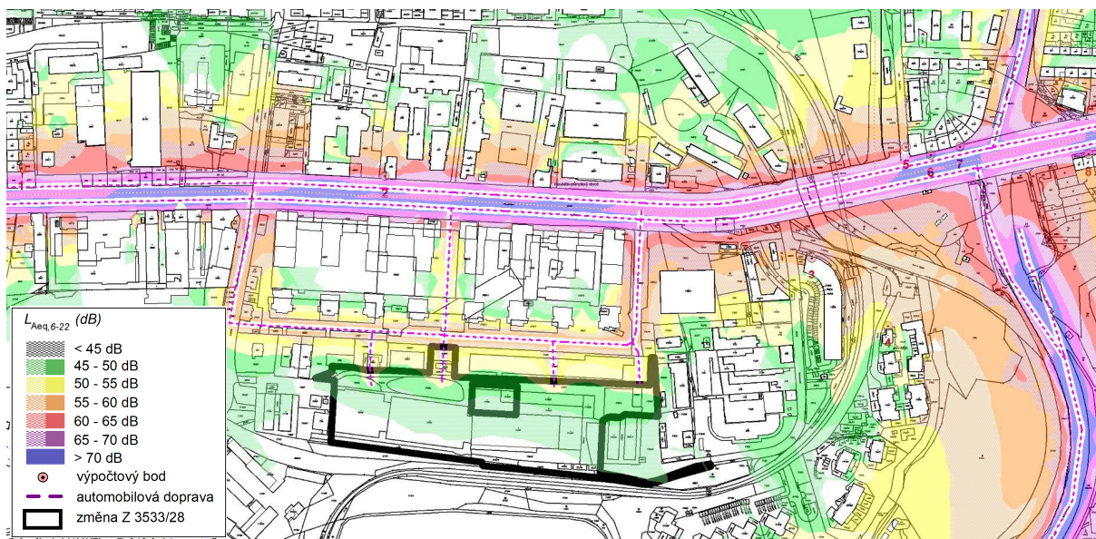
Obr. 6. L_{Aeq, 6 \text{ až } 22 \text{ hod}} , stav po změně, silniční doprava, izofony ve výšce 4 m nad terénem
