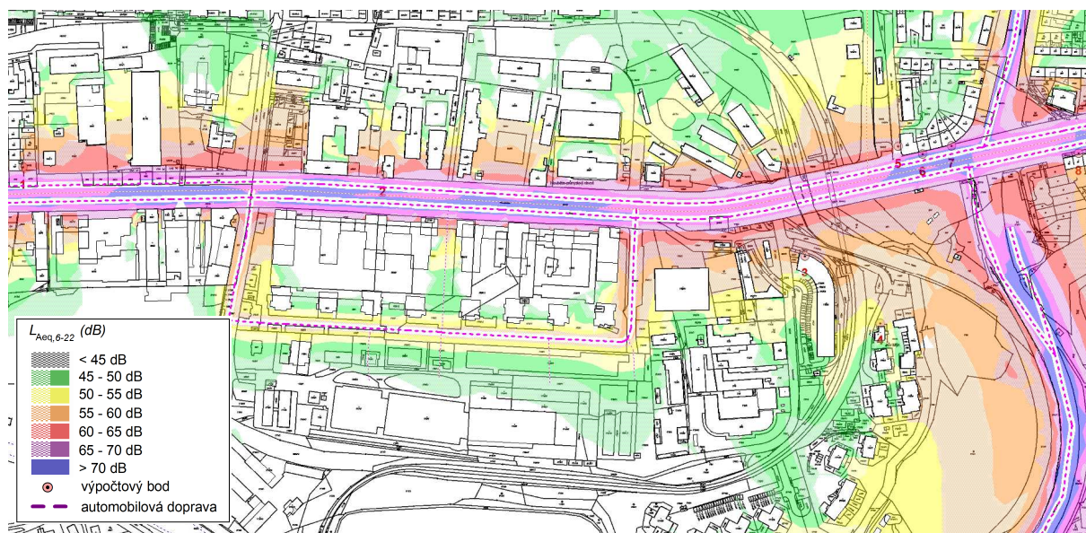
Obr. 4. L_{Aeq, 6 \text{ až } 22 \text{ hod}} , výchozí stav, silniční doprava, izofony ve výšce 4 m nad terénem
