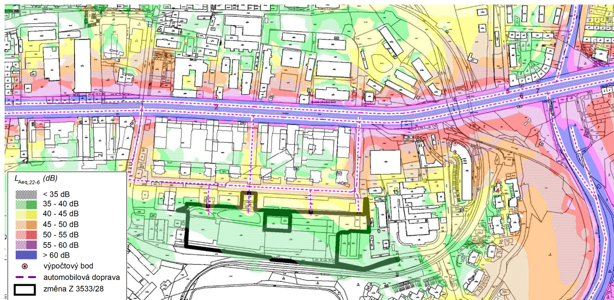
Obr. 7. L_{Aeq} , 22 až 6 hod, stav po změně, silniční doprava, izofony ve výšce 4 m nad terénem
