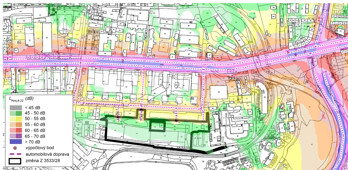
Obr. 8. L_{Aeq, 6 \text{ až } 22 \text{ hod}} , stav po změně v kumulaci, silniční doprava, izofony ve výšce 4 m nad terénem
